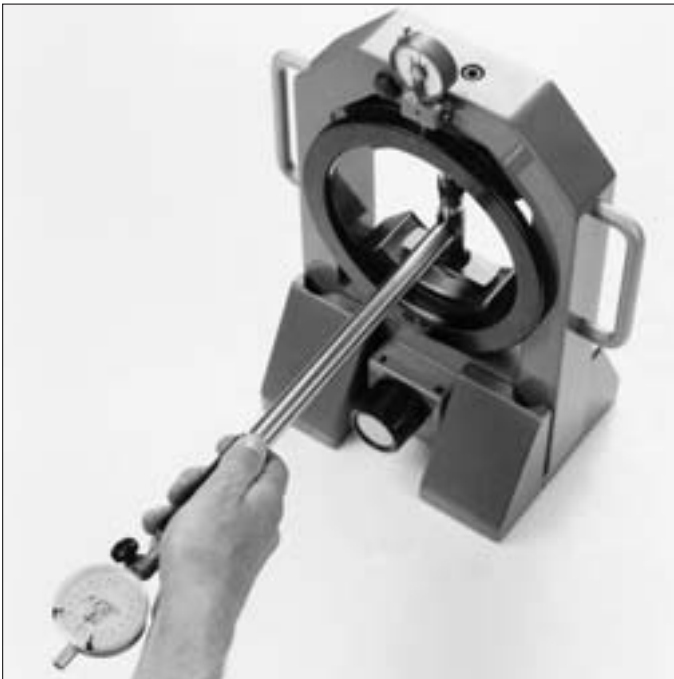
76: Das Maß des Laufbahndurchmessers wird mit dem Bohrkreismessgerät auf das Hüllkreismessgerät übertragen. Das Hüllkreismessgerät FAG MGA 31 verwendet man bei Zylinderrollenlagern mit abziehbarem Außenring, z.B. FAG NN30ASK.
