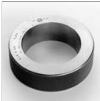
10: Kleine kegelige Lagersitze prüft man mit dem Kegel-Lehrring.
