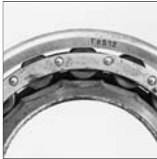
111: Ausgebrochener Bord eines Tonnenlagers, dessen Innenring mit Hammergeschlägen aufgetrieben wurde
