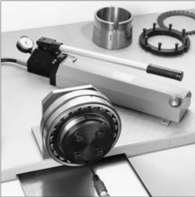
56: Einbau eines Pendelrollenlagers mit kegeliger Bohrung nach dem Hydraulikverfahren
