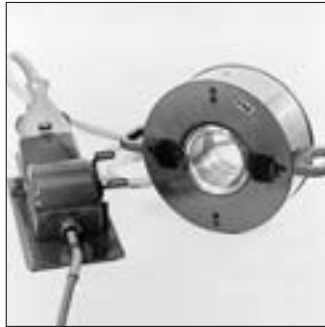
45: Induktive Montage- vorrichtung für 380 V beim Anwärmen eines Innenrings
