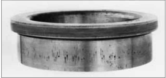
109: Schürfmacken in der Rollbahn eines Zylinderrollenlager-Innenringes
