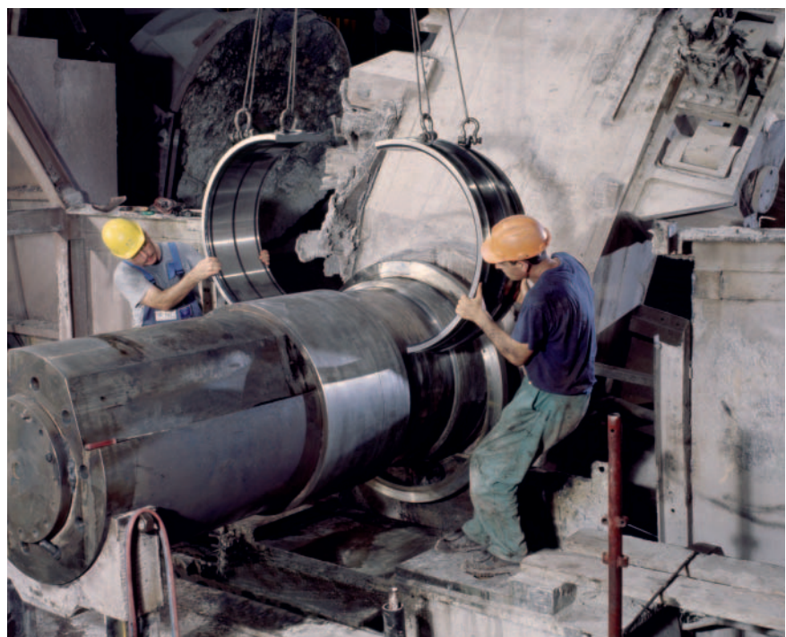
Montage eines großen geteilten Pendelrollenlagers
