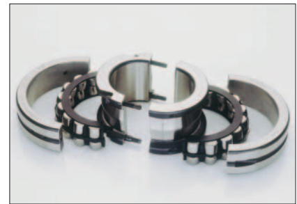
4: Geteiltes Pendelrollenlager mit geteiltem Massivkäfig aus glasfaserverstärktem Polyamid oder aus Messing, Spannringe integriert
