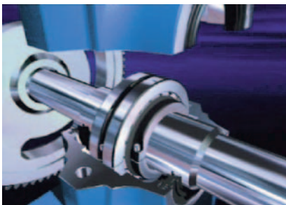
6 Zur Belastung des Lagers Welle absenken
